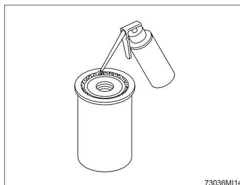
(10) Установите сливную пробку трансмиссии после ее очистки.
