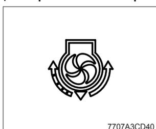
① Эта лампа горит, когда нажат выключатель управления вентилятором.
