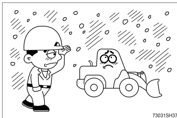
При работе или движении по заснеженной или обледеневшей дороге наденьте цепи на шины и не допускайте резких рывков, торможения и поворотов.
