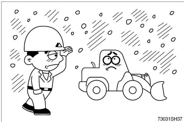
При движении по или работе на заснеженной или обледенелой дороге установите на колеса погрузчика цепи противоскольжения, и при работе избегайте резких троганий с места, торможений и поворотов.
