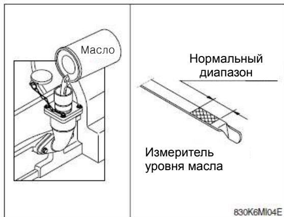
(10) Дайте поработать двигателю на малых оборотах холостого хода, и проверьте наличие утечек через места соединений масляных фильтров и через сливную пробку. Заглушите двигатель и проверьте щупом уровень моторного масла. После остановки двигателя выждите 15 минут до проверки, чтобы масло успело стечь в масляный картер.
