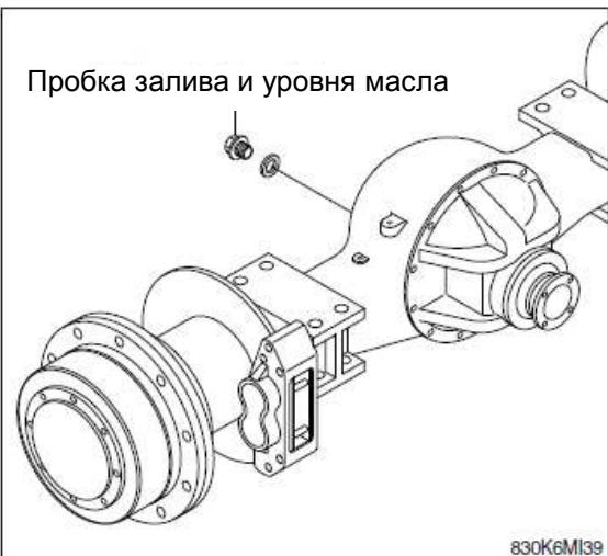
(4) Если уровень масла ниже отверстия пробки, добавьте масло через отверстие пробки.
