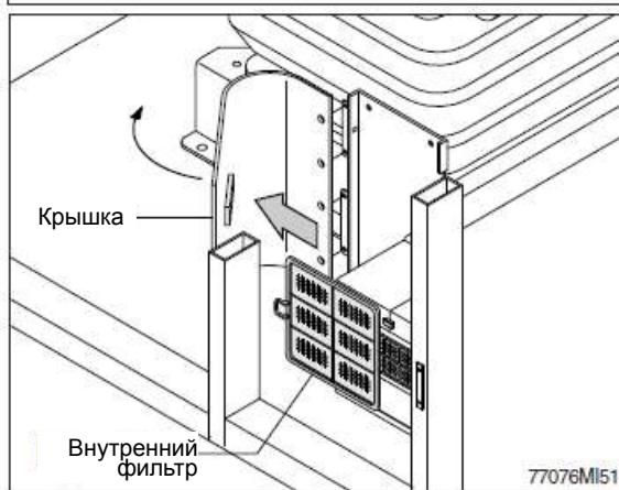
(3) Чистый внутренний фильтр с помощью сжатого воздуха (менее 2 кгс/см<sup>2</sup>, 28 psi) или промыванием водой.
