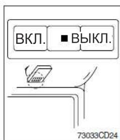
(1) Включает и выключает лампу освещения кабины
