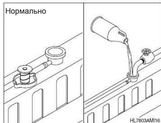
\* Заполнение системы охлаждения двигателя необходимо проводить в хорошо проветриваемом помещении. Откройте выпускной краник двигателя. Систему нужно заполнять медленно, чтобы не образовывались воздушные пробки. Подождите 2-3 минуты, чтобы вышел воздух, затем добавьте жидкость до горлышка.
