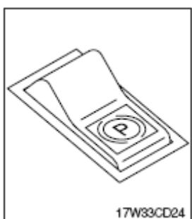
(1) Этот выключатель используется для управления стояночным тормозом.
