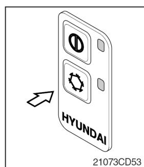
(1) Этот выключатель одновременно включает (ON) или выключает (OFF) компрессор и светодиодный дисплей.
