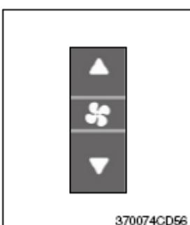
(1) Скорость вентилятора контролируется автоматически заданной температурой.
