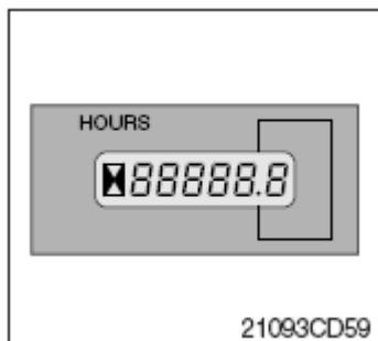
(1) Этот счетчик показывает общее количество моточасов, отработанных машиной.
