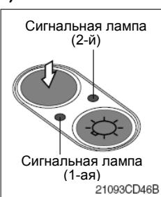
(1)Этот переключатель служит для управления дальним светом и рабочим освещением.
