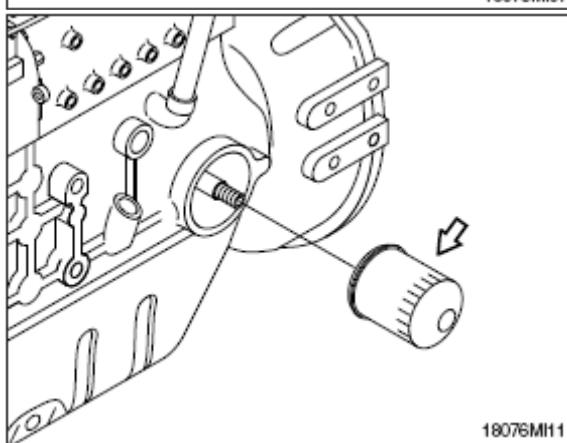
(4) Перед установкой фильтра нанесите на уплотнительную поверхность тонкий слой смазочного масла.
