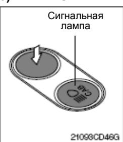
(1) Этот выключатель включает фонарь на кабине..
