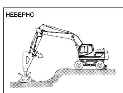
**5) ПРОДОЛЖИТЕЛЬНОСТЬ НЕПРЕРЫВНОЙ РАБОТЫ ГИДРОМОЛОТОМ ПРИ ФИКСИРОВАННОМ ПОЛОЖЕНИИ СТРЕЛЫ И РУКОЯТИ – НЕ БОЛЕЕ ОДНОЙ МИНУТЫ**
