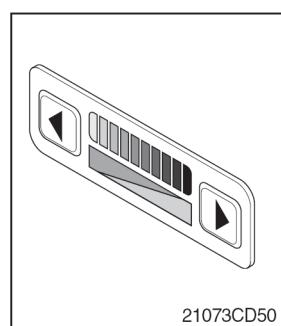
(1) Регулятор имеет 9 положений температуры воздуха от максимального холода до максимального тепла, которые выбираются последовательным пошаговым переключением вверх или вниз.
