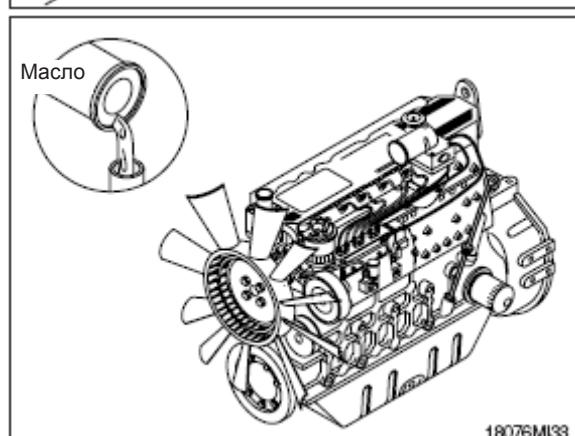
(7) Дайте двигателю поработать на низких оборотах и убедитесь в отсутствии утечек через фильтр и сливную пробку.
