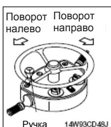
(1) При повороте рулевого колеса налево машина повернет налево, а при повороте направо – повернет направо.
