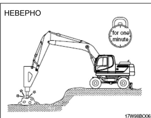
**6) ПРИ НАНЕСЕНИИ УДАРОВ ГИДРОМОЛОТОМ НЕ ПЕРЕМЕЩАЙТЕ МАШИНУ ИЛИ САМ ГИДРОМОЛОТ**
