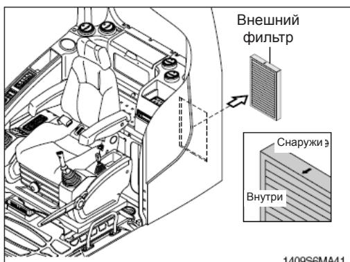
(3) Очистите фильтр сжатым воздухом (давлением ниже 2 кгс/см<sup>2</sup>, 28 фунтов на кв. дюйм).
