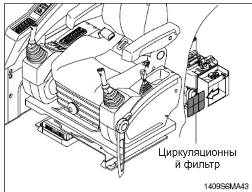
(3) Очистите циркуляционный фильтр сжатым воздухом (давлением ниже  $2 \text{ кгс}/\text{см}^2$ , 28 фунтов на кв. дюйм) или промойте водой.
