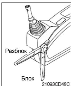
(1) При установке рычага в положение «БЛОКИРОВАНО» все педали и рычаги управления блокированы.
