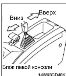
(1) Этот рычаг используется для управления отвалом бульдозера или выносной стрелой, используя селекторный переключатель 1.(бульдозер / выносная стрела).
