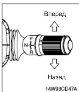
① Этот рычаг изменяет направление хода машины.
