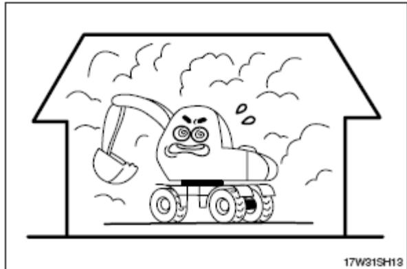
Проверьте расположение подземных коммуникаций газопроводов и водопроводов и обеспечьте должную их и свою безопасность перед выполнением работ и при работе.
