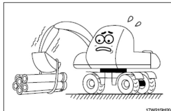
Избегайте езды в поперечном направлении на уклоне, так как это может стать причиной опрокидывания или соскальзывания.
