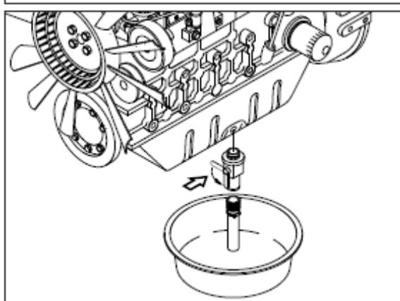
(3) Очистите поверхность вокруг головки фильтра, снимите фильтр с помощью ключа фильтра и очистите поверхность прокладки.
