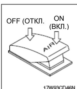
(1) Этот переключатель используется для включения или отключения воздушного компрессора.
