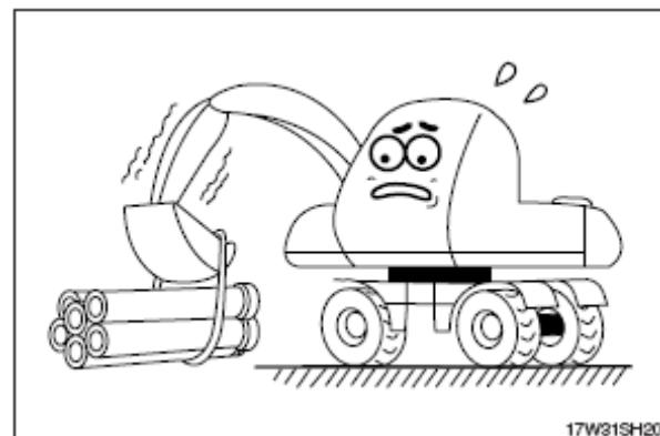
Избегайте езды в поперечном направлении на уклоне, так как это может стать причиной опрокидывания или соскальзывания.
