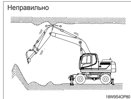
10) Не используйте ковш для разрушения твердых кусков породы, таких как бетон или камень. Это может привести к поломке зубьев, пальцев или погнуть стрелу.
