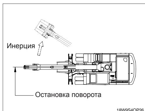
9) Не используйте силу веса рабочего оборудования, предназначенного для копания, для забивания в грунт свайных элементов. Машина может повредиться в результате удара.
