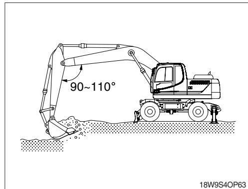
6) При работе машины оставляйте небольшие безопасные зазоры для хода гидроцилиндров с целью исключения повреждения гидроцилиндров.
