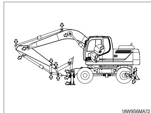
\* Если они установлены неправильно, будет иметь место быстрый износ пальцев и втулок, а также повышенный шум и вибрации при работе экскаватора.
