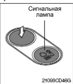
(1) Этот выключатель включает фонарь на кабине..
