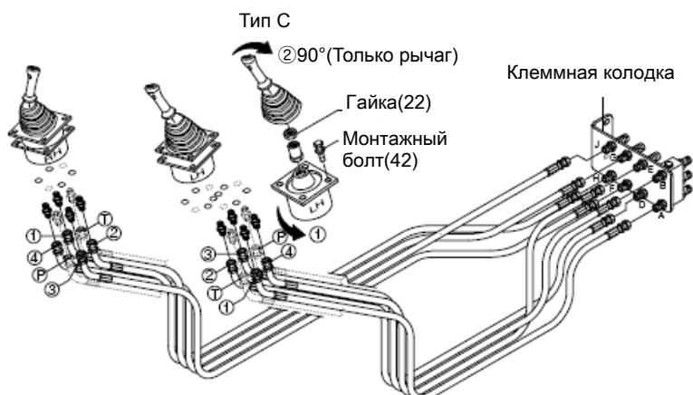
\* Каждый раз, когда в данной схеме управления машиной происходят изменения, производите такие же изменения на табличке схемы управления в кабине. Схема на табличке ОБЯЗАТЕЛЬНО должна совпадать с настоящей схемой управления машиной.
