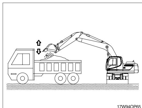
8) При остановке вращения поворотной платформы принимайте во внимание силы инерции, которые дополнительно поворачивают поворотный круг после возвращения рычага управления вращением в нейтральное положение.
