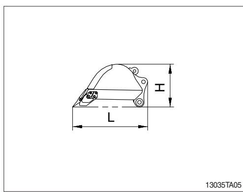
\* Ковш 0,76 м<sup>3</sup> (0,99 ярд<sup>3</sup>) по стандарту SAE (включая зубья и боковые режущие кромки).
