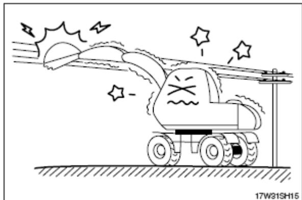
Если машина коснется высоковольтного провода, оставайтесь сидеть на своем рабочем месте в кабине и предупредите персонал о том, чтобы никто не касался экскаватора до отключения тока в линии электропередачи. При необходимости покинуть машину, спрыгивайте с нее, не касаясь машины.
