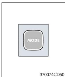
(1) При использовании этого выключателя звучит сигнал и по порядку отображаются символы режимов
