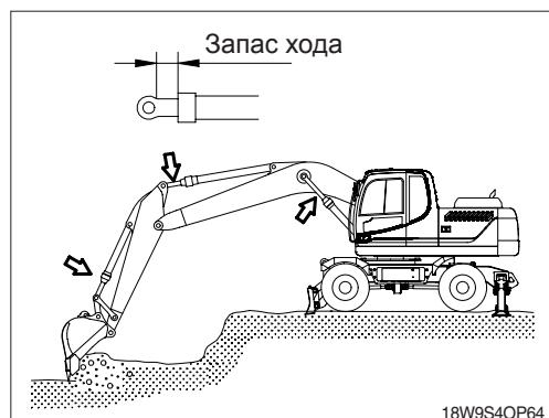
7) При разгрузке грунта из ковша держите рукоять в горизонтальном положении, а ковш в положении выгрузки.
