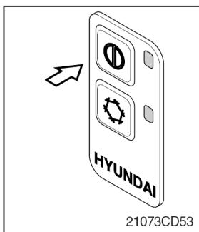
(1) Этот выключатель одновременно включает (ON) или выключает (OFF) систему и светодиодный дисплей.
