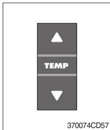
(1) Установка индикации температуры (18~31°C, шкала : 1°C)
