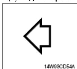
① Эта лампа мигает при передвижении левого мультифункционального переключателя в положение назад.
