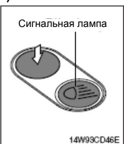
(1)Этот выключатель используется для управления рабочим освещением.
