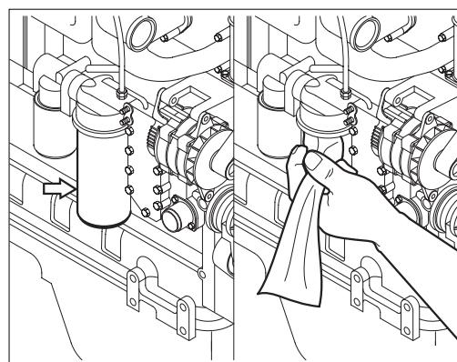
(6) Перед установкой фильтров нанесите тонкий слой смазки на прокладку посадочной поверхности фильтров.
