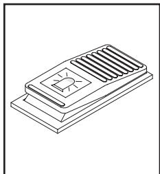
(1) При нажатии на этот выключатель включается врачающийся проблесковый маячок на кабине.
