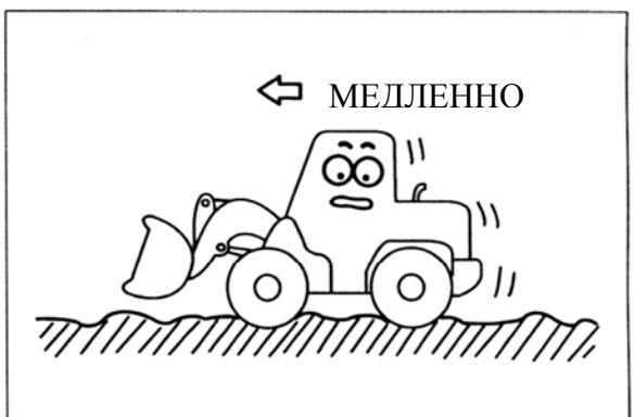
При работе в воде или пересечении отмелей проверьте состояние грунта под водой, а также глубину и скорость течения воды, и лишь после этого приступайте к работе , постоянно следя, чтобы уровень воды не был выше уровня корпуса редуктора моста.
