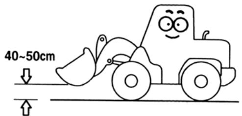
Избегайте резких поворотов и торможений при загруженном ковше. Перегруз ковша опасен. Убедитесь в том, что вес груза в ковше не превышает допустимой величины.
