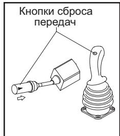
(1) Не разрешается включать данную кнопку при включенной первой передаче. Нажмите и отпустите кнопку. Автоматически включится первая передача, обеспечивая в то же время защиту двигателя от работы "вразнос".
