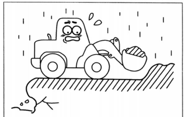
Данная машина предназначена только для выполнения экскавационных и погрузочных работ. Не используйте ее для перетаскивания материалов. В отличие от крана погрузчик не оснащен устройствами, необходимыми для безопасного перемещения материалов.
