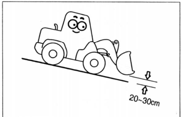
Изменять направление движения погрузчика при движении на уклоне опасно.
