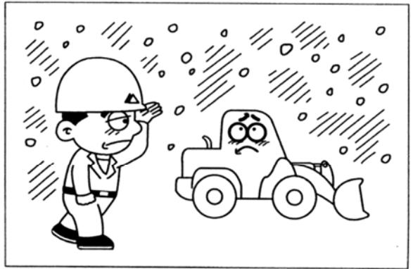
При движении по или работе на заснеженной или обледенелой дороге установите на колеса погрузчика цепи противоскольжения, и при работе избегайте резких троганий с места, торможений и поворотов.
