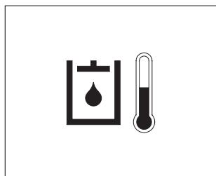
(1) Эта лампа загорается одновременно с сигналом зуммера при температуре жидкости выше 105°C (221°F).
