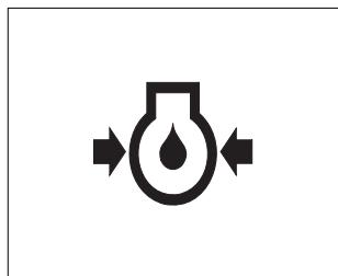
(1) Включение этой лампы при запуске двигателя означает низкое давление масла в двигателе.
