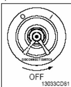
(1) Этот переключатель служит для полного отключения всей электросистемы (в задней части машины, где противовес).
