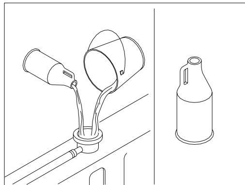
② Установите крышку радиатора. Дайте поработать двигателю до тех пор, пока температура охлаждающей жидкости достигнет 80 °C и убедитесь в отсутствии утечек.
