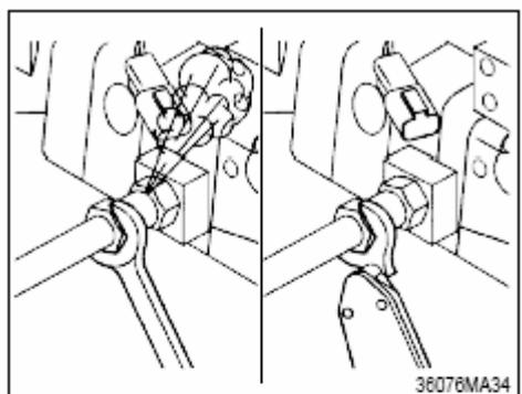
③ Места выхода воздуха в трубопроводах из насоса давления в топливный насос могут быть локализованы путем работы насосом давления или кнопкой переключателя для создания давления в топливной системе. Проверьте все трубы, соединения и топливный фильтр на отсутствие внешних утечек топлива.
