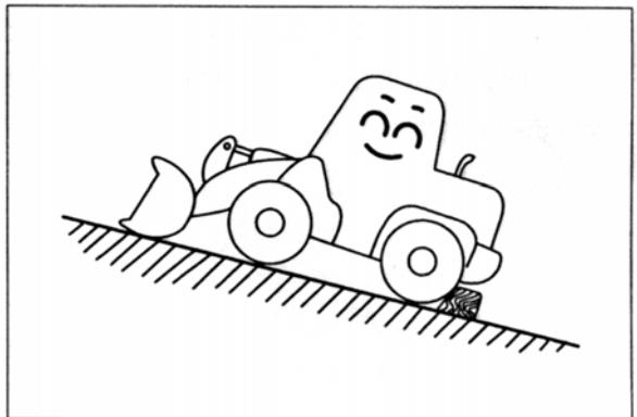
На уклонах избегайте перемещения погрузчика в поперечном направлении, так как это может привести к его переворачиванию или соскальзыванию.
