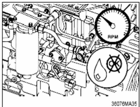
④ Открытая форсунка также может втянуть рабочий газ назад в насос, и в сливной трубе появится воздух. Если двигатель работает с перебоями, разомкните форсунки всех трубопроводов на конце насоса. Запустите двигатель и осмотрите трубопроводы. Если Вы замечаете, что газ проходит назад в трубу, это означает, что форсунка постоянно открыта.
