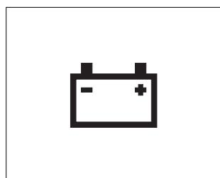
(1) Эта лампа загорается при пуске двигателя и гаснет после его запуска.
