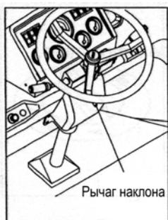
(1) Рулевое колесо можно наклонить, опуская этот рычаг.
