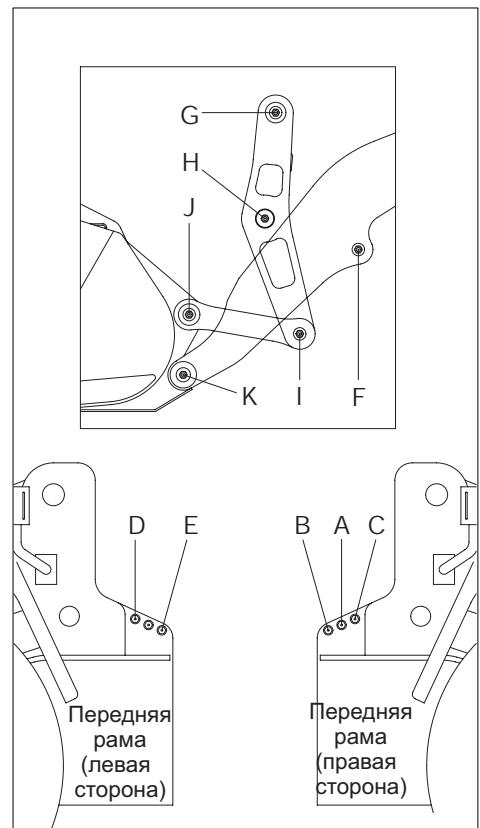
\* Уменьшайте интервалы смазки при работе в воде или запыленных условиях.
