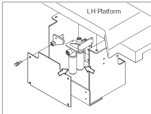
(8) Перед установкой головки фильтра нанесите тонкий слой консистентной смазки на посадочную поверхность под прокладку головки фильтра.
