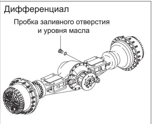
(4) Если уровень масла ниже отверстия пробки, добавьте масло через отверстие пробки.
