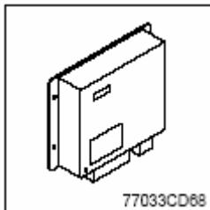
(1) Он состоит из электронных компонентов и управляет всеми лампами и зуммерами на панели контрольных дисплеев в соответствии с электронными сигналами, поступающими от сенсоров переключателей, модулей управления трансмиссией и двигателем (ECM, TCU) и от сенсоров датчиков гидравлического давления.
