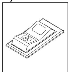
(1) Аварийная система рулевого управления может быть протестирована вручную. Нажмите этот переключатель, чтобы определить, работают ли аварийное рулевое управление и контрольная лампа аварийного рулевого управления.
