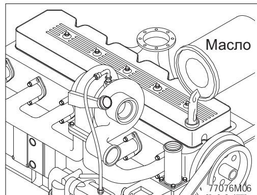
(10) Дайте поработать двигателю на малых оборотах холостого хода, и проверьте наличие утечек через места соединений масляных фильтров и через сливную пробку.
