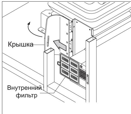
(3) Очистите внутренний фильтр потоком сжатого воздуха под давлением не более 2 атмосфер или промойте его водой.
