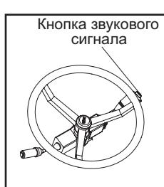
(1) При нажатии на эту кнопку, расположенную в центре рулевого колеса, происходит подача звукового сигнала
