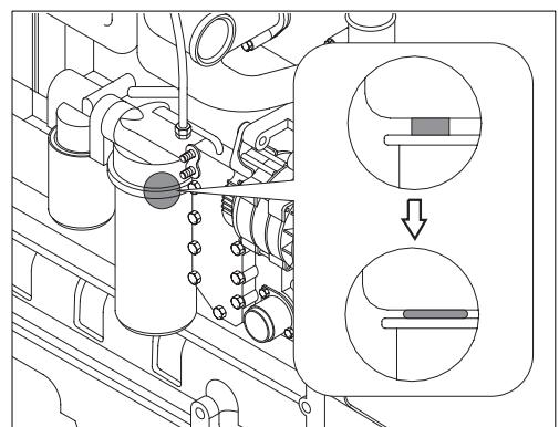
(7) Прочистите и осмотрите резьбу сливной пробки и поверхность уплотнений. Замените сливную пробку, если обнаружены повреждения. Установите ее и крепко затяните.
