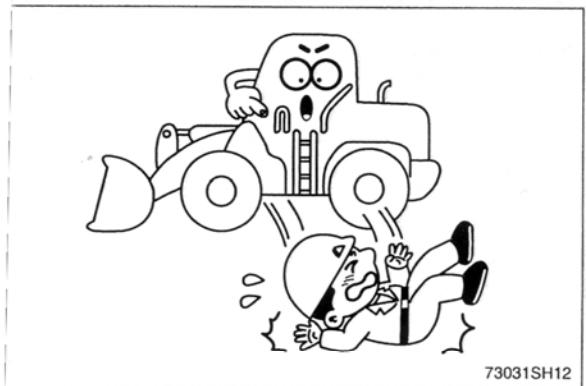
Перед началом работы подайте звуковой сигнал для предупреждения близстоящего персонала о начале работы машины.
