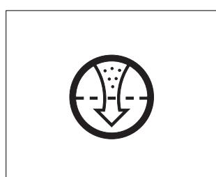
(1) Эта лампа загорается при разряжении воздуха вследствие загрязнения фильтра воздухоочистителя.
