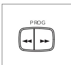
① При однократном нажатии этой кнопки во время проигрывания кассеты направление движения пленки изменится на противоположное.
