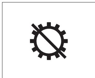
(1) Эта лампа загорается и ЖК дисплей показывает коды неисправностей при возникновении неисправности в коробке передач.
