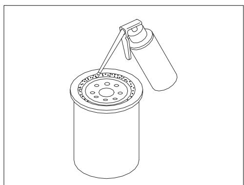
(4) Установите новый фильтр и затяните уплотнительное кольцо на корпусе фильтра. Затяните фильтр на 1/2-3/4 поворота.
