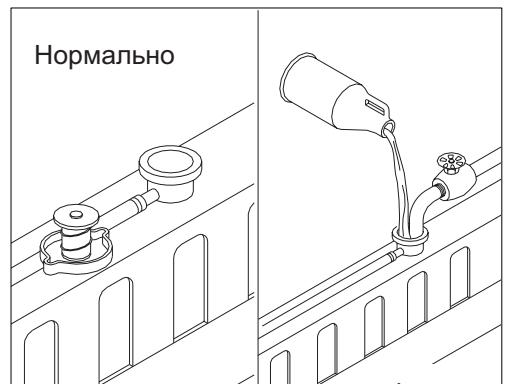
※ Во время заливки промывочной жидкости воздух должен выходить через воздушные каналы. Воздух выходит к верхнему баку радиатора через воздушный клапан, расположенный в верхней и передней частях крышки цилиндра. Для двигателей со вторичным охладителем существует дополнительное вентилирование.
