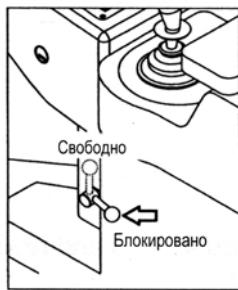
(1) При установке рычага в положение «БЛОКИРОВАНО» (LOCK) перекрывается гидросистема управления рабочим оборудованием, и тем самым оно блокируется.
